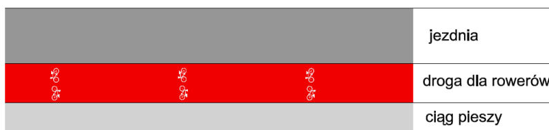
Rys. 7 Przykład usytuowania drogi dla rowerów, nie oddzielonej (od ruchu samochodowego i pieszego).
