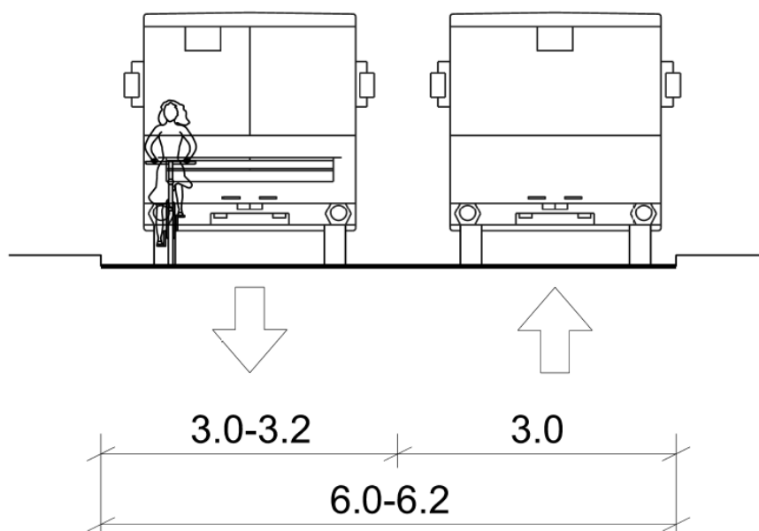
Rys. 22 Przykład rozwiązania przekroju jezdni autobusowej wykorzystywanej wspólnie przez ruch rowerowy i autobusowy. Przy szerokości pasa autobusowo-rowerowego 3.0-3.2m.
